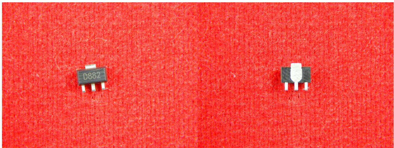
Биполярный транзистор — трёхэлектродный полупроводниковый прибор, один из типов транзисторов. В полупроводниковой структуре сформированы два р-п-перехода, перенос заряда через которые осуществляется носителями двух полярностей — электронами и дырками.
