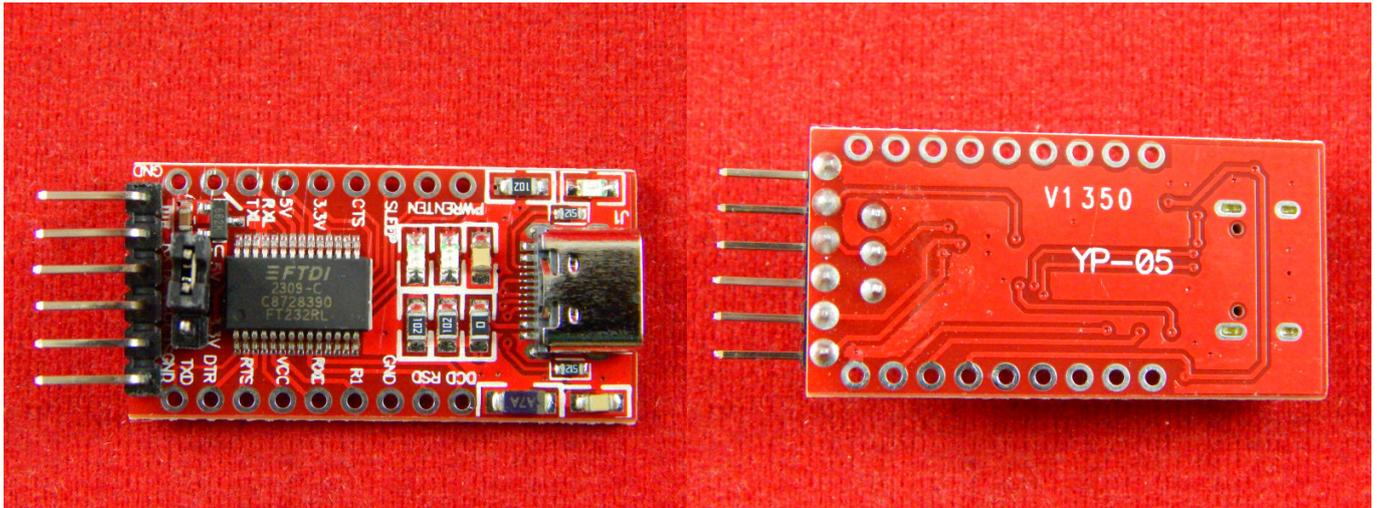
Конвертер USB-UART на основе FT232RL предназначен для организации виртуального COM-порта с уровнями TTL для взаимодействия с внешними устройствами, например Arduino.
