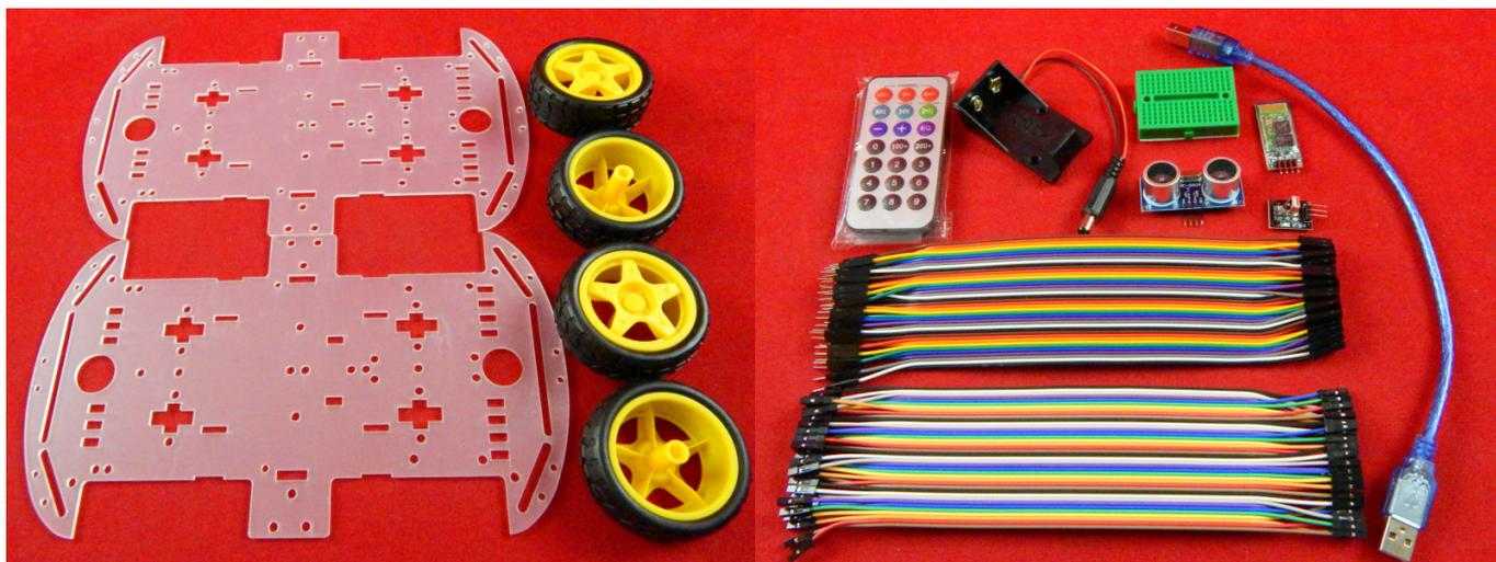
Набор четырехколесной машинки на Arduino 4WD - это комплект, предназначенный для создания и программирования автономного транспортного средства на базе микроконтроллера Arduino. Набор включает в себя все необходимые компоненты для сборки машинки, включая шасси, четыре мотора с колесами, плату управления, батарейный блок, провода и другие мелочи.
