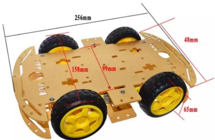
**Габариты колёс и мотор-редукторов:**
