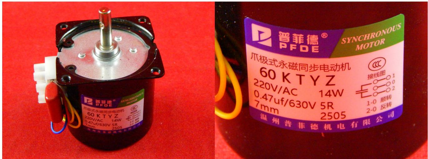
Синхронный двигатель с редуктором с питанием 220 VAC серии 60KTYZ мощностью 14 Вт. Диаметр вала - 7 мм. Синхронные мотор-редукторы серии 60KTYZ применяются в kleевых дозаторах, в приборах сценического освещения, в медицинском оборудовании, в офисной технике, в бытовой технике, в бытовых и промышленных инкубаторах, в приводах шнеков для твердотопливных котлов и другом промышленном оборудовании.
