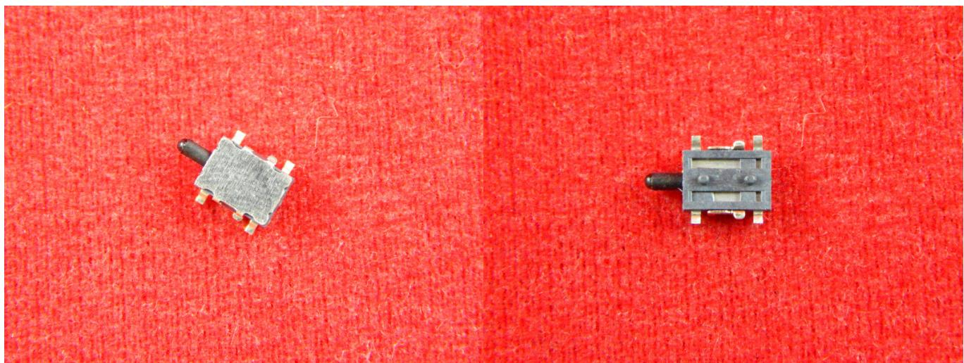
DSA02 - это малогабаритный тактовый переключатель, используемый в портативной электронике, например: мобильные телефоны, пульты, GPS-устройства и так далее.
