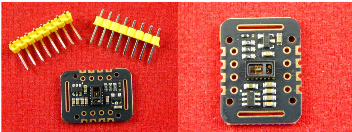
Датчик пульсоксиметрии MAX30102 - это плата с интегрированным сенсорным модулем, которая позволяет определять частоту сердечных сокращений, то есть пульс, а также уровень насыщения крови кислородом (SpO<sub>2</sub>). Помимо этого, в сенсор встроен температурный датчик, с помощью которого вы можете получить значение температуры окружающей среды.
