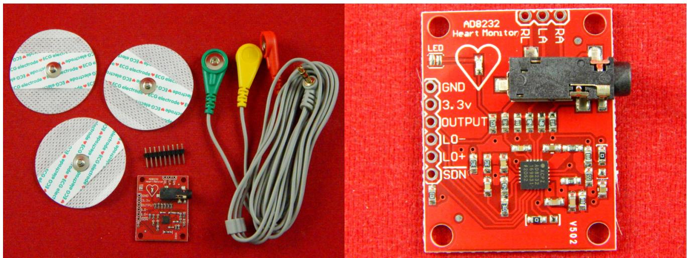
Датчик сердечного ритма, ЭКГ AD8232 — датчик, используемый для обработки электрокардио- и электромио- сигналов.
