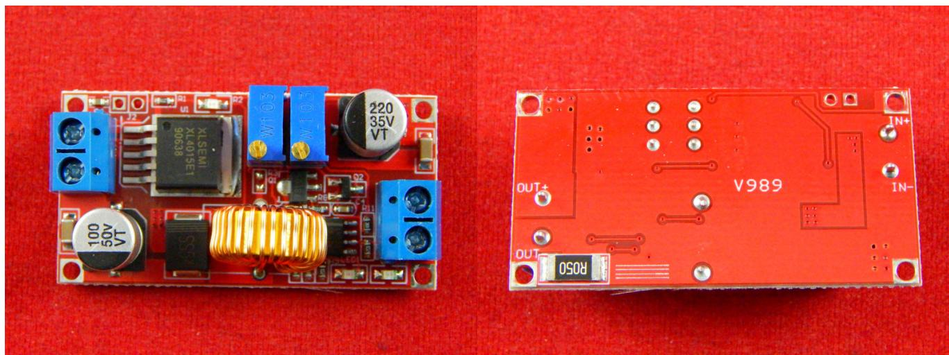
Понижающий преобразователь – вид импульсного стабилизатора напряжения, предназначенного для построения шин питания в схемах с гальванической развязкой. Выходное постоянное напряжение понижающего DC-DC конвертера не может превышать входное постоянное напряжения. Базируется на основе чипа XL4015. Выходное напряжение модуля регулируется подстрочным резистором.
