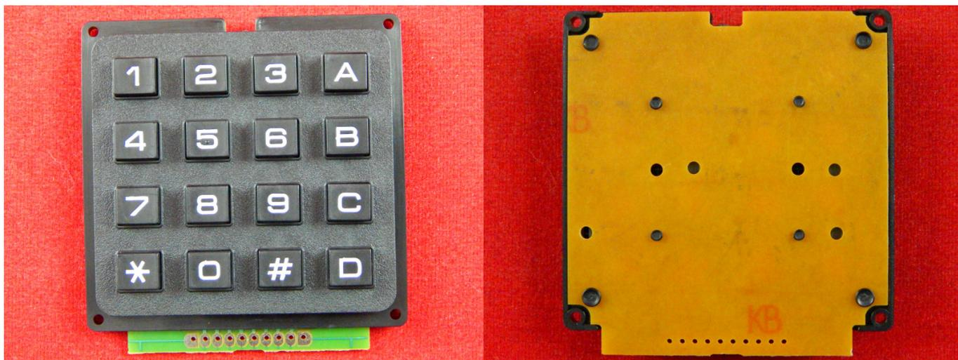
Мембранная клавиатура 4x4 — это плёночная панель с 16 кнопками, расположенными в виде матрицы 4 строки × 4 столбца.
