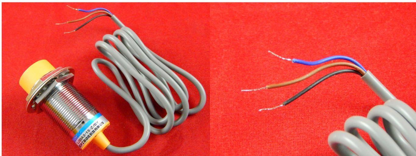
LJ30A3-15-Z/BY — это индуктивный бесконтактный датчик приближения цилиндрической формы (Ø30), с PNP логикой, нормально открытый (NO) выход, используется для обнаружения металлических объектов без физического контакта.
