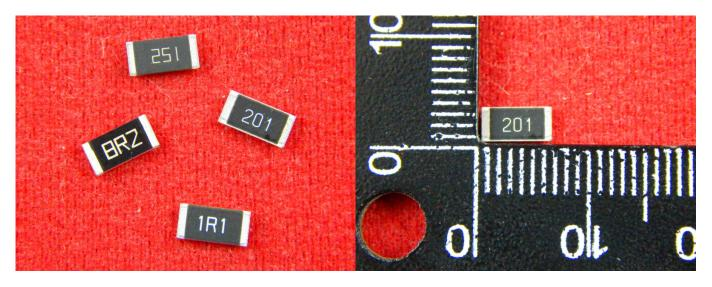
SMD резисторы - это миниатюрные резисторы, предназначенные для поверхностного монтажа.
