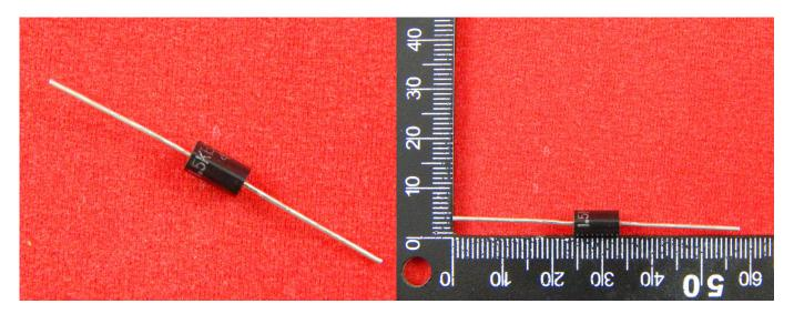
Ограничительный диод 1.5КЕЗ6СА обеспечивает высокую защиту от перенапряжения. Диод предназначен для защиты чувствительного электронного оборудования от переходных процессов напряжения вызванных событиями переходного напряжения. Номинальное напряжение пробоя диода 36 В.
