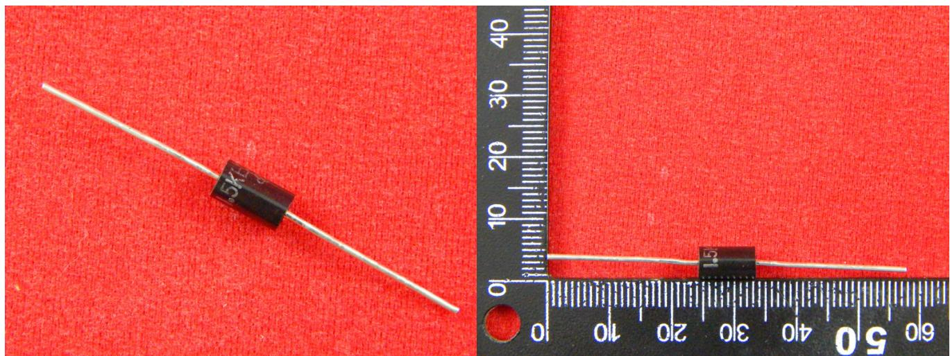
Ограничительный диод 1.5KE36CA обеспечивает высокую защиту от перенапряжения. Диод предназначен для защиты чувствительного электронного оборудования от переходных процессов напряжения вызванных событиями переходного напряжения. Номинальное напряжение пробоя диода 36 В.
