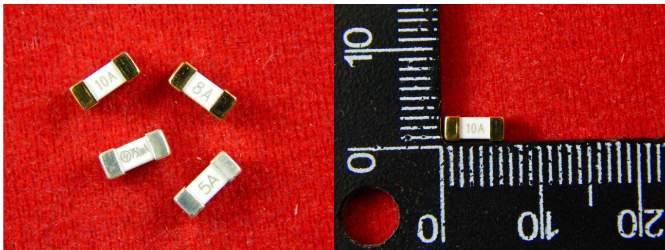
SMD предохранители 2410 пригодны для использования под пайку и под установку в разъемы. Использование керамического материала обеспечивает высокую устойчивость к высоким температурам и надежность в работе. Особенностью данных предохранителей является их действие с задержкой, данное условие необходимо для нормальной работы некоторых электроустановочных изделий, что делает их отличным выбором.
