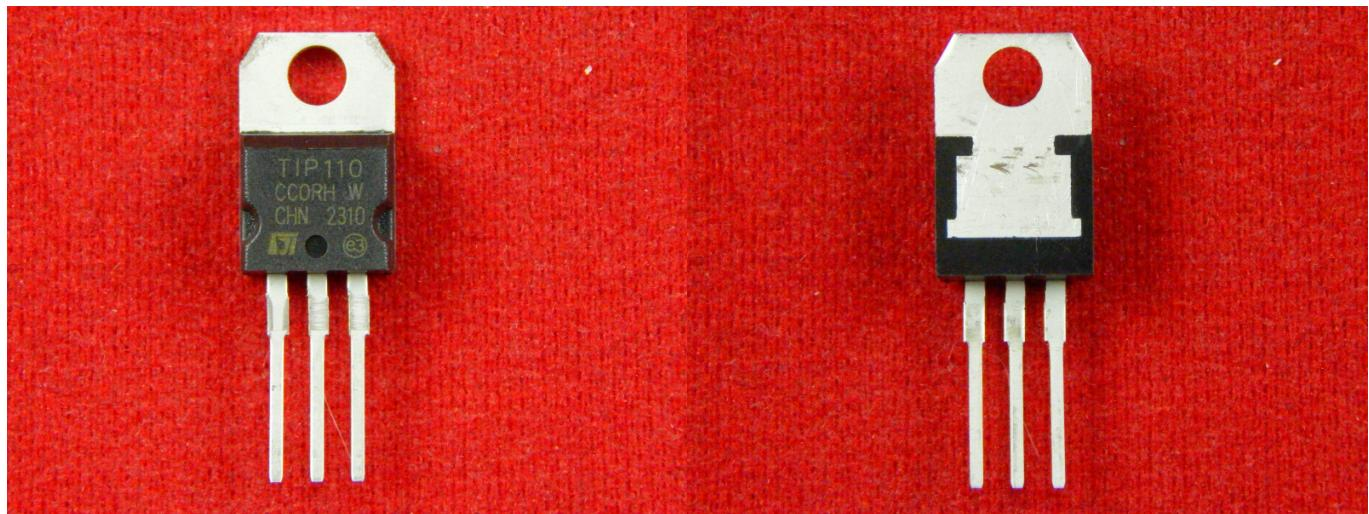
TIP110 — это кремниевый NPN-транзистор Дарлингтона средней мощности, выпускаемый в корпусе ТО-220АВ. Главная особенность: очень большой коэффициент усиления по току  $hFE > 1000$  благодаря конфигурации Дарлингтона (два транзистора в одном кристалле).
