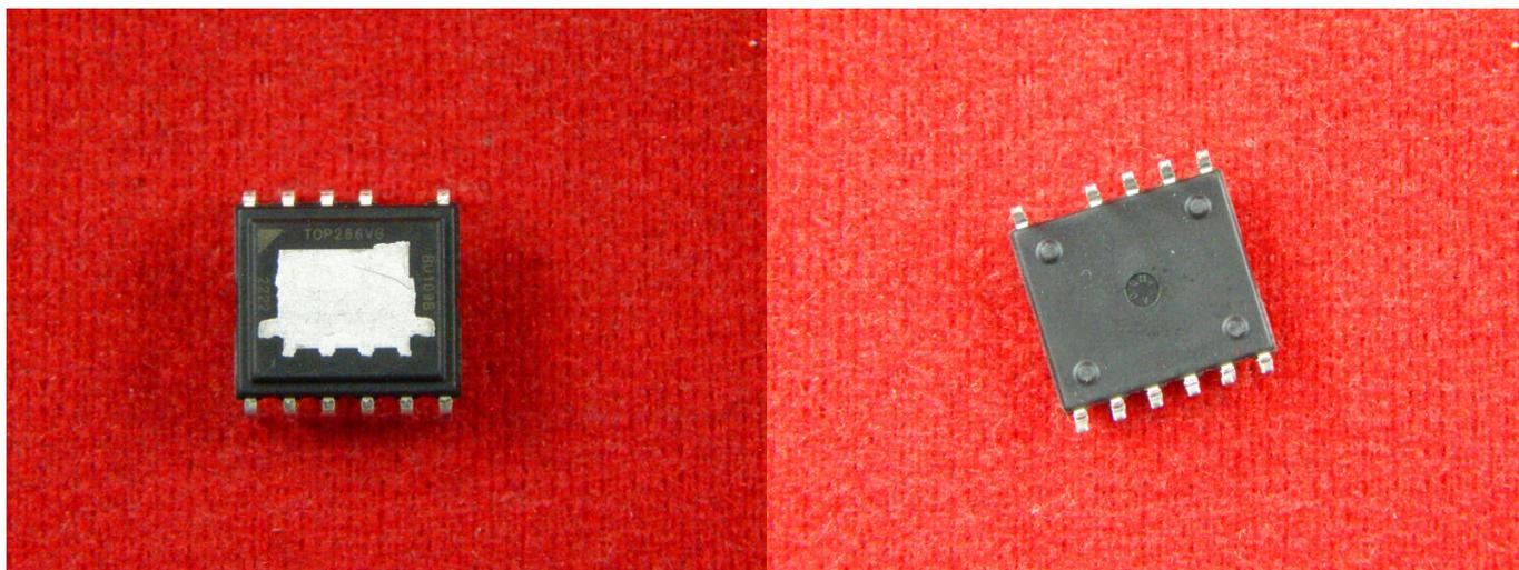
TOP266VG — это высокоинтегрированный ШИМ-контроллер с MOSFET на борту, серия TOPSwitch-JX. Он предназначен для построения импульсных блоков питания (SMPS) мощностью от 85 Вт до 230 Вт, в зависимости от схемы и охлаждения.
