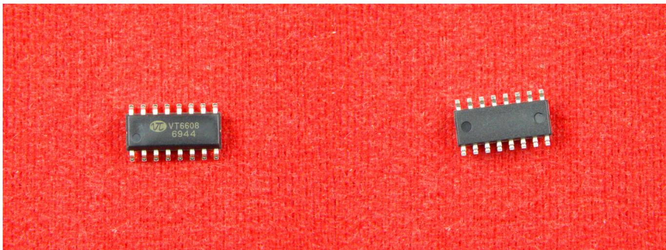
VT6608 используется в автомобильных приборах для управления шаговыми двигателями, которые отвечают за отображение показаний на спидометре, тахометре и других аналогичных устройствах. Она преобразует цифровые сигналы в управляющие импульсы, которые приводят в движение шаговый двигатель, обеспечивая точное и плавное изменение показаний. Является аналогом VID6608.
