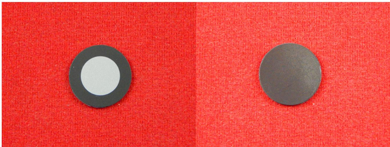
Магнитные маркеры (метки) размером 12/19 мм для ручных лазерных 3D-сканеров. Имеют четкий контур на границе между белой и черной частями что позволяет получить максимальную точность при сканировании. Выполнены на специальной пленке с низким светоотражением.
