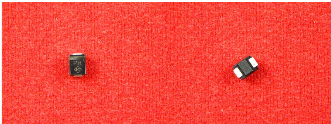
SMBJ170A — это односторонний TVS диод, предназначенный для защиты чувствительных электронных компонентов от перенапряжений, вызванных молнией, переключением индуктивных нагрузок и другими импульсными помехами.
