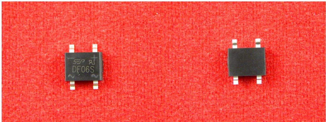
DF06S — компактный однофазный выпрямительный диодный мост, предназначенный для преобразования переменного тока в постоянный. Подходит для применения в блоках питания, адаптерах, зарядных устройствах, LED-драйверах и другой бытовой и промышленной электронике.
