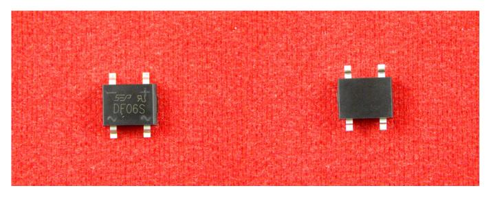
DF06S — компактный однофазный выпрямительный диодный мост, предназначенный для преобразования переменного тока в постоянный. Подходит для применения в блоках питания, адаптерах, зарядных устройствах, LED-драйверах и другой бытовой и промышленной электронике.
