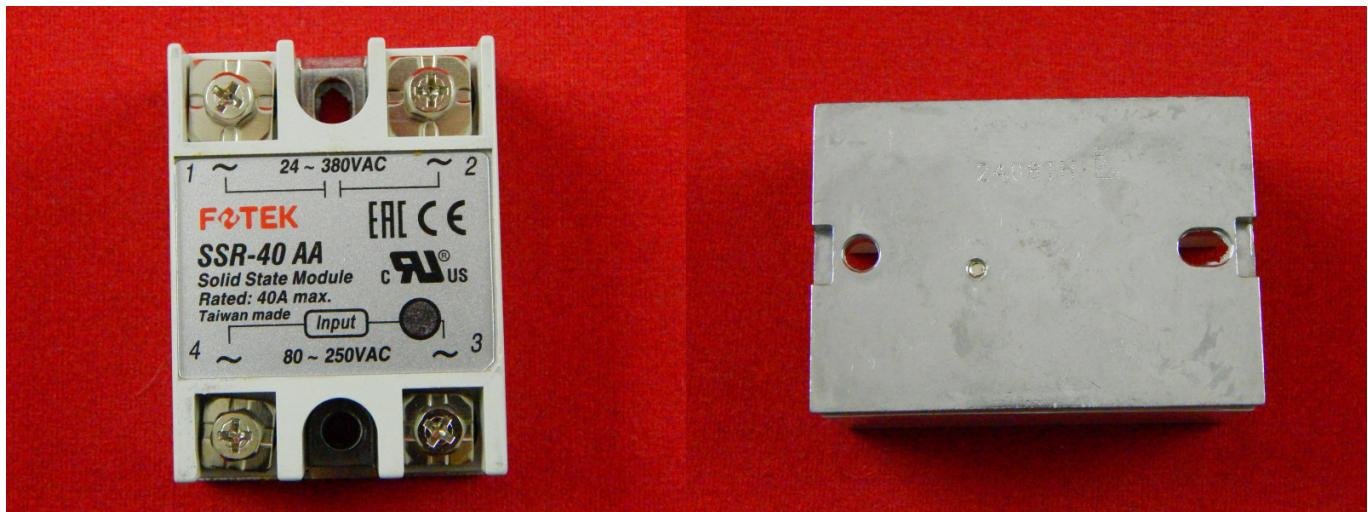
SSR-40AA - однофазное твердотельное реле для управления нагрузками переменного тока. Используется для включения/отключения AC-нагрузок без механических контактов, с высокой надёжностью и долговечностью.
