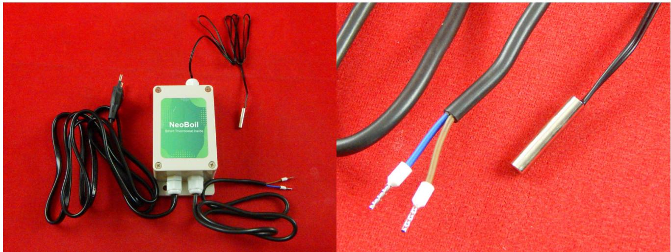
Данный блок предназначен для удаленного контроля и управления температуры: угольных, газовых и электро котлов отопления. Также подходит для: теплиц, грибниц, инкубаторов, холодильных и морозильных камер, складов и других помещений где требуется точный контроль за температурой воздуха или теплоносителя локально, или удаленно через интернет.
