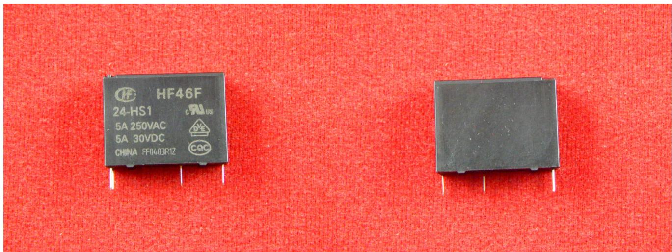
HF46F-24-HS1 — это компактное электромагнитное реле с катушкой на 24 В DC, предназначенное для коммутации цепей переменного и постоянного тока. Устанавливается на печатную плату, обладает высоким уровнем изоляции и длительным сроком службы.
