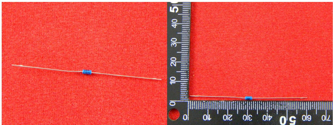
Диод триистор DB4 представляет собой высококачественный динистор в корпусе DO-35 для монтажа ТНТ. Этот компонент идеально подходит для широкого спектра областей применения, требующих надежного управления мощностью. Благодаря своим характеристикам, DB4 обеспечивает стабильную работу в различных электронных схемах.
