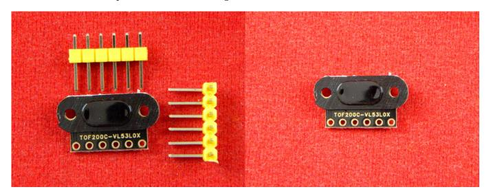
ТОF-дальномеры — это так называемые простейшие лидары, способные обнаруживать объекты препятствий для движущего устройства и расстояние до них при помощи инфракрасного излучения с длиной световой волны 940 нм. Это наиболее высокоточный метод определения.
