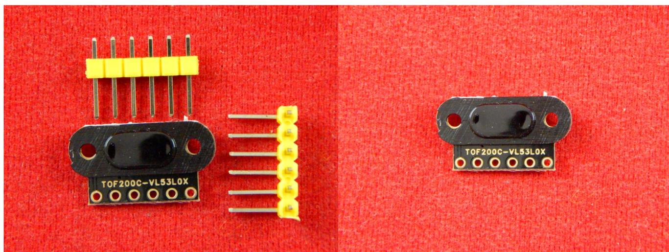
TOF-дальномеры — это так называемые простейшие лидары, способные обнаруживать объекты препятствий для движущего устройства и расстояние до них при помощи инфракрасного излучения с длиной световой волны 940 нм. Это наиболее высокоточный метод определения.
