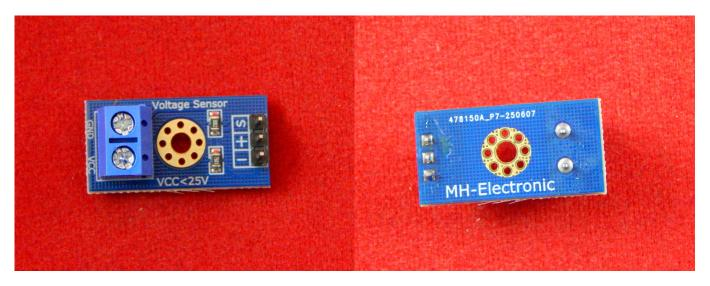
Компактный модуль измеряет постоянное напряжение 0...25 В, понижая его в 5 раз до уровня, безопасного для АЦП микроконтроллеров (5 В/3,3 В). Минимально детектируемое напряжение  $\sim 0.02445$  В (при 10-бит АЦП и опорном 5 В). Подключение: клеммник VCC/GND (измеряемое), гребёнка S/-/+ к МК. Отлично подходит для Arduino, ESP32/ESP8266, STM32 и др.
