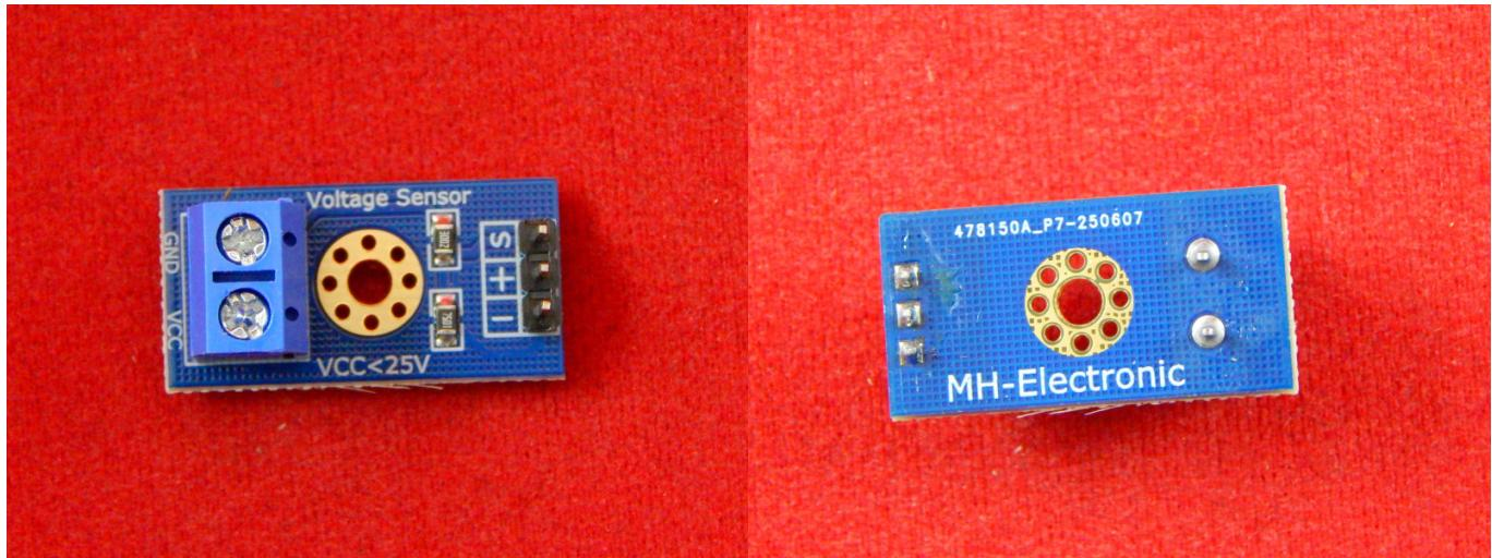
Компактный модуль измеряет постоянное напряжение **0...25 В**, понижая его в **5 раз** до уровня, безопасного для АЦП микроконтроллеров (5 В/3,3 В). Минимально детектируемое напряжение **~0,02445 В** (при 10-бит АЦП и опорном 5 В). Подключение: клеммник **VCC/GND** (измеряемое), гребёнка **S/-/+** к МК. Отлично подходит для Arduino, ESP32/ESP8266, STM32 и др.
