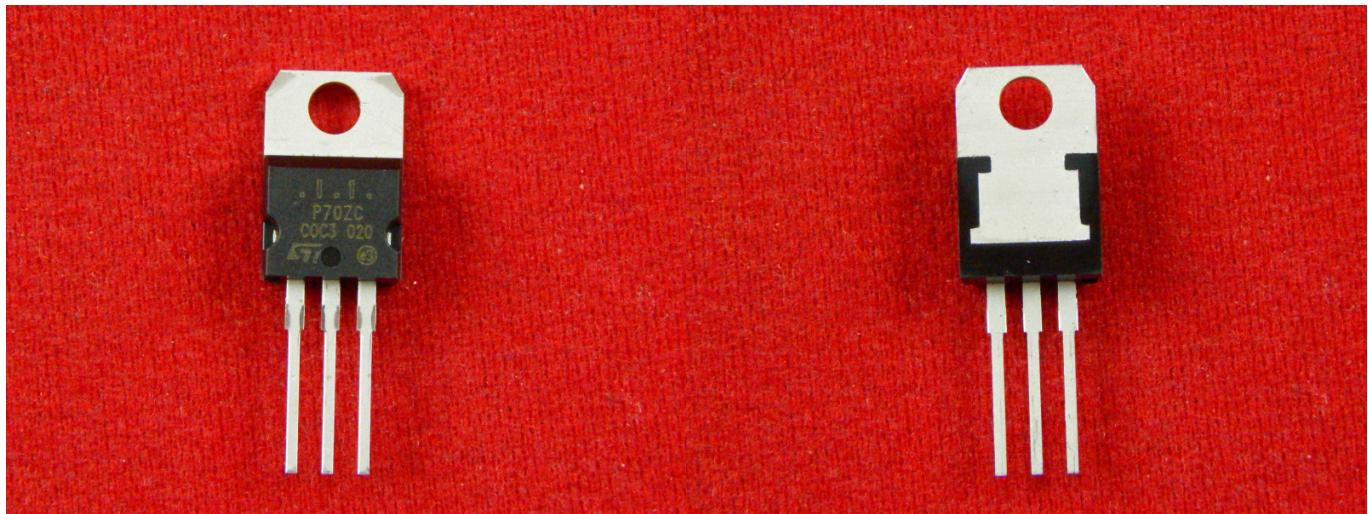
Мощный N-канальный MOSFET **STP70NS04ZC** от **STMicroelectronics**. Работает при напряжении до **33 В**, выдерживает ток **80 А** и обладает сверхнизким сопротивлением канала (**8 мΩ тип.**). Используется в автомобильных системах, включая **ABS-модули**, драйверы соленоидов, мотор-контроллеры и DC-DC преобразователи. Корпус **TO-220**.
