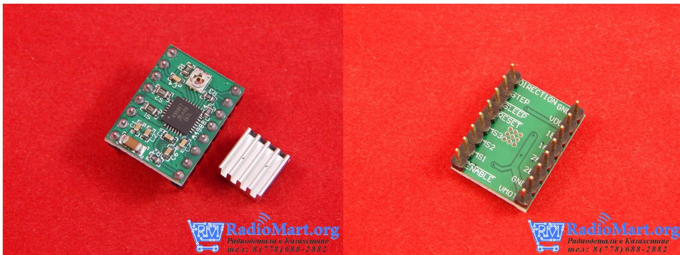
StepStick драйвер шаговых двигателей, построенный на чипе Allegro's A4988 DMOS. Используется совместно с платой RAMPS Mega Shield, для создания недорогих 3D принтеров. Поставляется в комплекте с радиатором.
