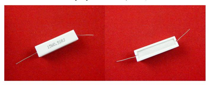
Резисторы керамические проволочные цементные - резисторы, номинальное сопротивление которых Вы выбираете сами с рассеиваемой мощностью - 15Вт. Предназначены для эксплуатации в цепях постоянного или переменного тока, обеспечивая ограничение силы тока и распределение напряжения. Монолитная керамическая конструкция обладает: огнестойкостью, влагостойкостью и способностью к самозатуханию.
