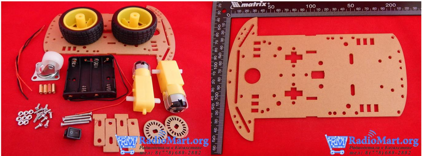
Набор для сборки колесной платформы с двумя приводными колесами и одним шарнирным для разворота.
