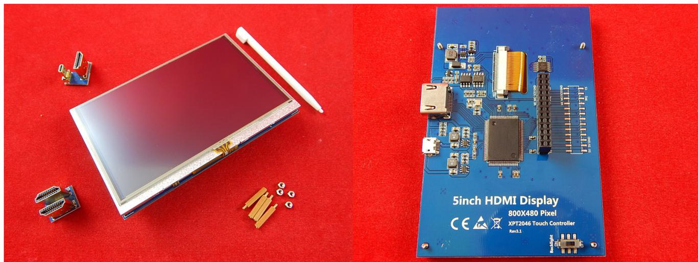
Пятидюймовый сенсорный дисплей для [RaspberryPi](#) отлично послужит вам для придания мобильности вашим разработкам. Передача изображения происходит через HDMI переходник, который идет в комплекте. Регулируемая подсветка снижает энергопотребление. Вы можете использовать его не только с [RaspberryPi](#), но и с другими платами, например: [Cubieboard](#).
