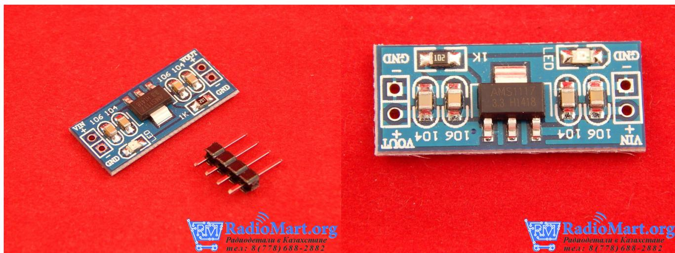
Стабилизатор напряжения, понижает входное напряжение до 3.3 вольт. Входное напряжение варьируется от 4.5В до 7В.
