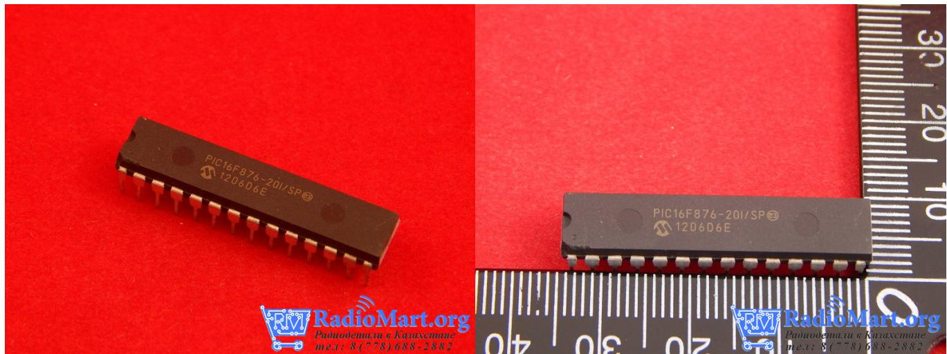
PIC16F876-20I/SP 8-битный микроконтроллер в SPDIP-28 корпусе
