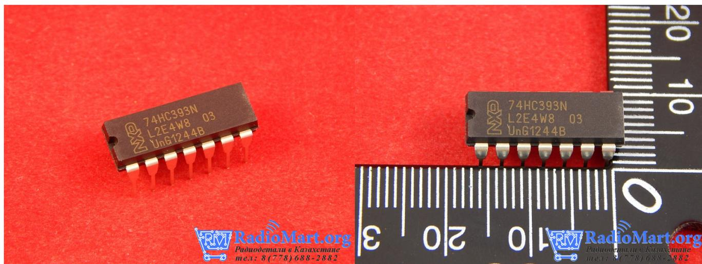
74НС393N Два 4-битных двоичных счетчика
