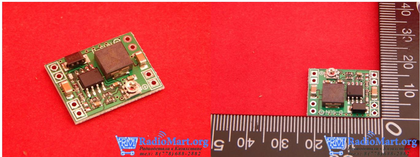
Преобразователь напряжения (понижающий) на микросхеме MP1584EN с регулировкой
