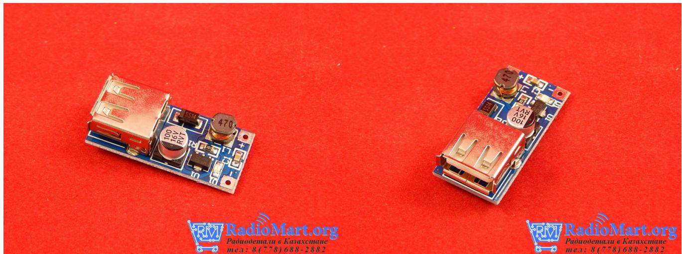
Этот модуль, может быть использован для питания-зарядки мобильного телефона, камеры и других цифровых устройств.
