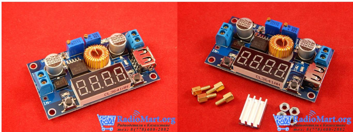
DC-DC регулируемый преобразователь с индикатором выходного и входного напряжения, вход 4-38В, выход 1,25 - 36В, ток 5А
